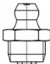
Smarowniczki kulkowe ciśnieniowe z główką stożkową DIN 71412 odmiany A,B,C
